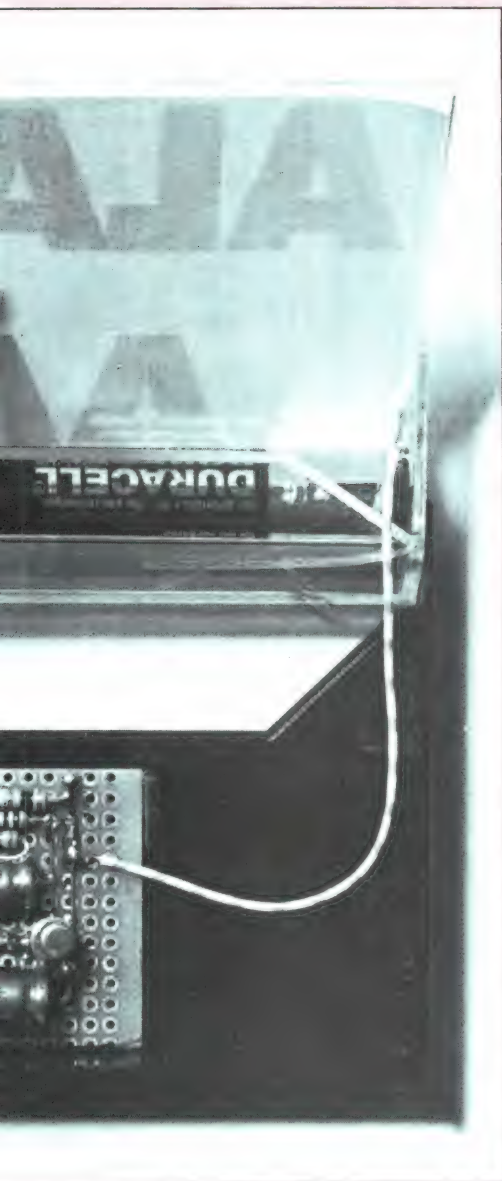
Foto 3. De montage van het geheel in het lege cassette-doesje. Met één stel alkalinebatterijen: 3 maanden knipperlicht voor slechts 4 gulden.
